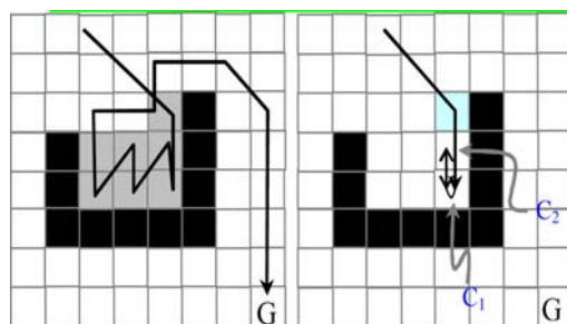
الف- با اعمال قواعد بهبود نیافته اتوماتا ربات درون تععر مانع و میان سلولهای C_1 و C_2 به دام می‌افتد ب- با اعمال قواعد بهبود یافته ربات ناحیه تععر را با فرمون علامت گذاری می‌کند و با اجتناب از سلولهای فرمون از ناحیه تععر آن خارج می‌شود.
